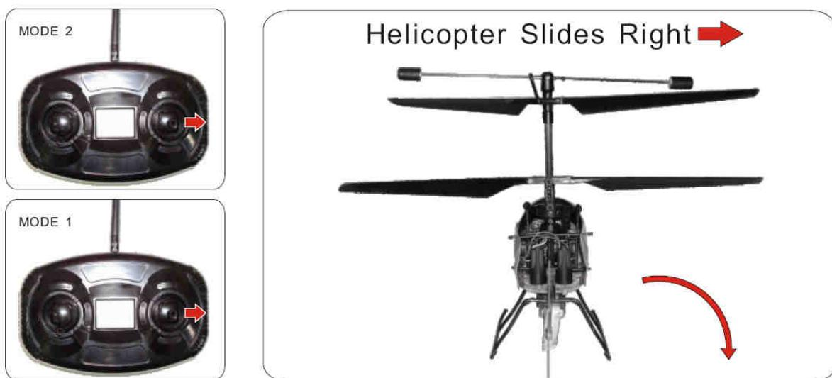
Verwenden Sie die Querrudertrimmung, um zu verhindern, dass der Helikopter im Schwebeflug, ohne Querrudereingabe, nach rechts oder links fliegt. Sollte der Helikopter im Schwebeflug z.B. nach rechts fliegen, erhöhen Sie die Querrudertrimmung nach links, bis der Helikopter ohne Flugbewegung nach rechts möglichst stabil ausgerichtet bleibt. Nachdem Sie sich mit den Hauptsteuerfunktionen vertraut gemacht haben, sind Sie beinahe bereit für den ersten Flug.
