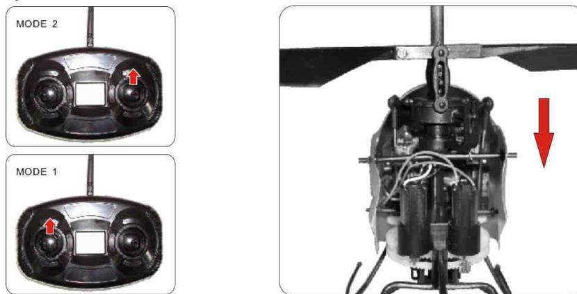
4. Wenn der Hebel zurückgezogen wird, sollte der rechte Servo die Taumelscheibe nach oben drücken.
