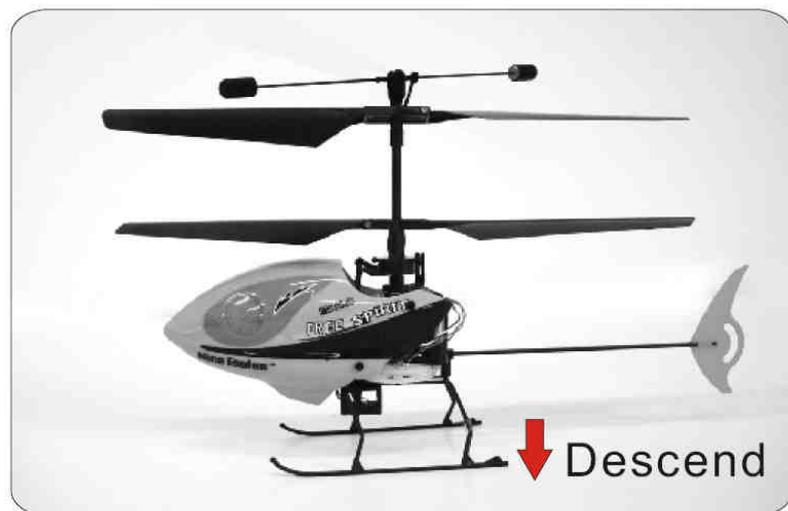
Verringern Sie die Rotationsgeschwindigkeit der Hauptrotorblätter, indem Sie den Gashebel nach unten drücken, und das Modell sinkt.
