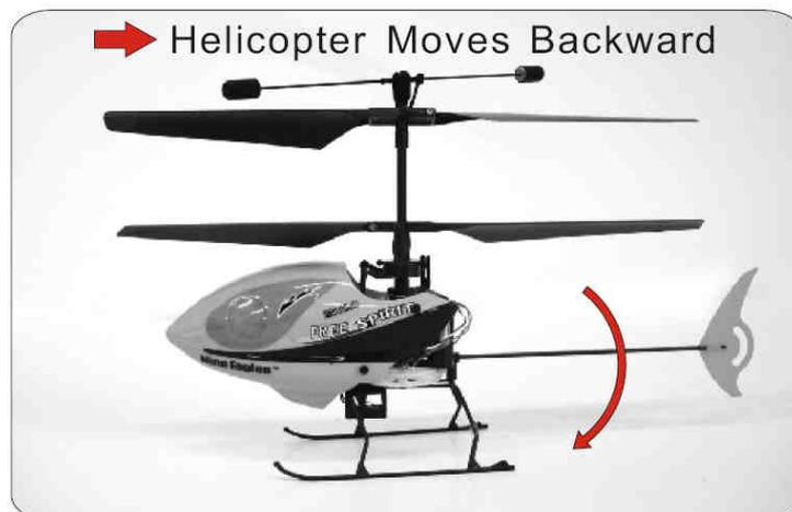
Verwenden Sie die Höhenrudertrimmung, um zu verhindern, dass der Helikopter im Schwebeflug, ohne Seitenrudereingabe, vorwärts oder rückwärts fliegt. Sollte der Helikopter im Schwebeflug z.B. vorwärts fliegen, trimmen Sie das Höhenruder (rückwärts), bis der Helikopter ohne Vorwärtsbewegung möglichst stabil ausgerichtet bleibt.
