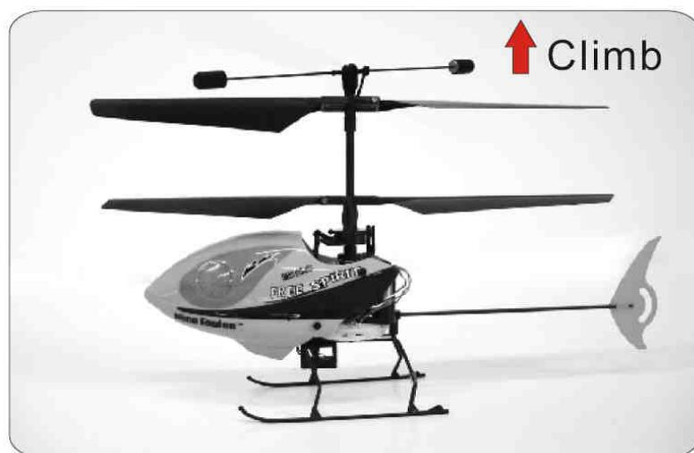
Bewegen Sie den linken Hebel nach links und die Nase des Helikopters giert um die Achse des Hauptrotorschafths nach links. Dieses wird durch die Erhöhung der Rotationsgeschwindigkeit des unteren Hauptrotors und durch die Verringerung der oberen Hauptrotorgeschwindigkeit verursacht.
